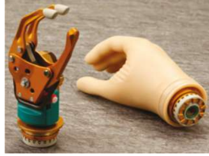
Şekil 1 Myoelektrik el 3 parmak kavramalı
